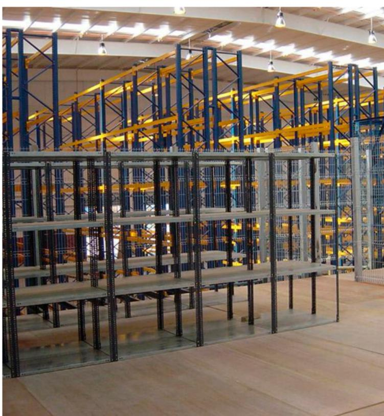
El equipamiento ANRA es el mejor representante del tradicional sistema de estanterías para almacenaje de cargas livianas o medianas, al cual se le han incorporado los avances tecnológicos de construcción antisísmica, lo que permite diseñar soluciones de hasta 9.0 mts. de altura.
