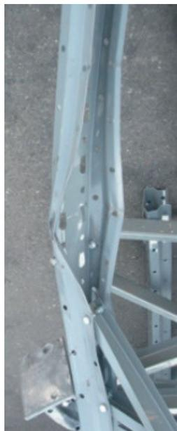
Figura 3.5 Pandeo distorsional en una sección de pilar tipo omega
