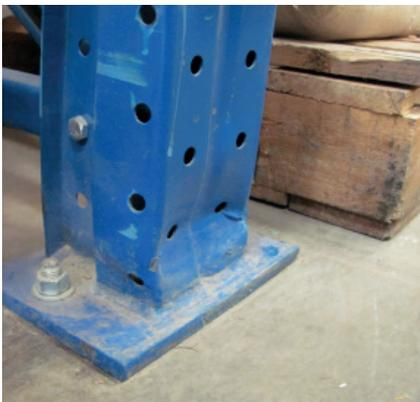
Figura 3.6 Pandeo local en la base de un pilar
