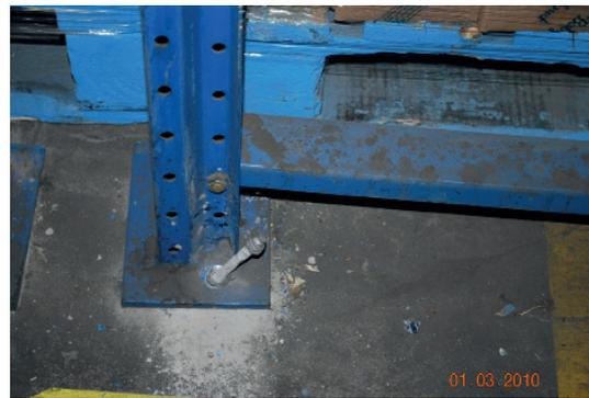
Figura 3.9 Falla por extracción del perno
